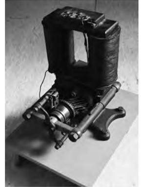
Der erste Elektromotor erzeugte eine Spannung von 440 Volt Gleichstrom bei einer Leistung von 5 PS und war im Anwesen Gerberei Zeno Heilmaier
