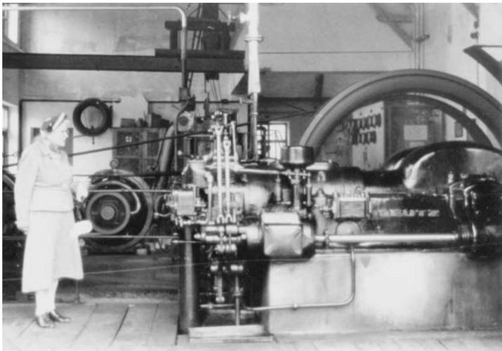
Erste mit Erdgas betriebene Zweizylinder Gasmachine Marke Deutz 120 PS 300 U/Min. im Elektrizitätswerk Isen.
